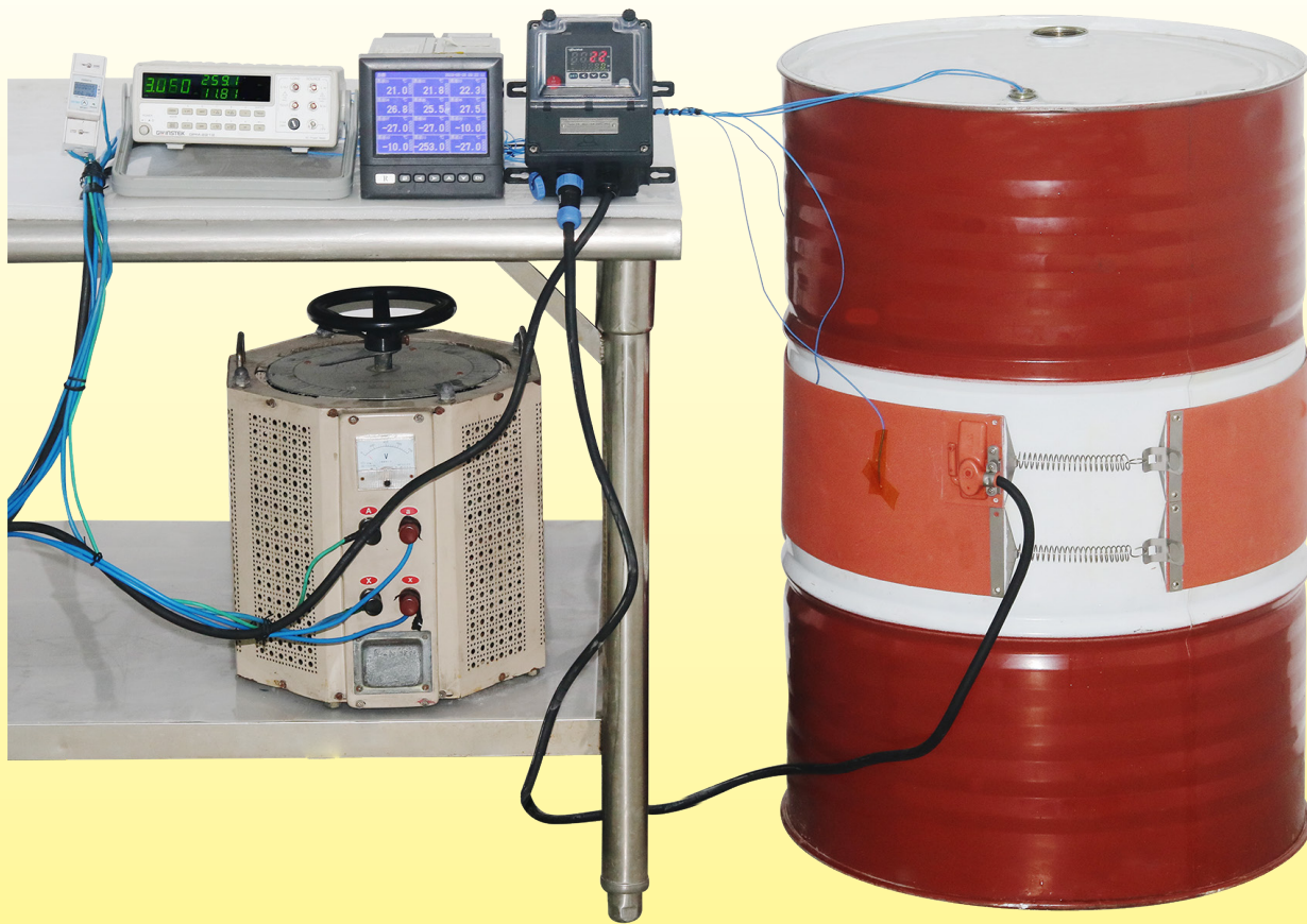
Temperaturverlauf in Abhängigkeit von der Zeit eines 220Liter-Metalfasses, gefüllt mit Wasser, beheizt durch einen Silikonheizgurt 200mm breit, ohne Wärmeisolation, Leistung 1500W (Oberflächenlast 0,5W/cm²).
