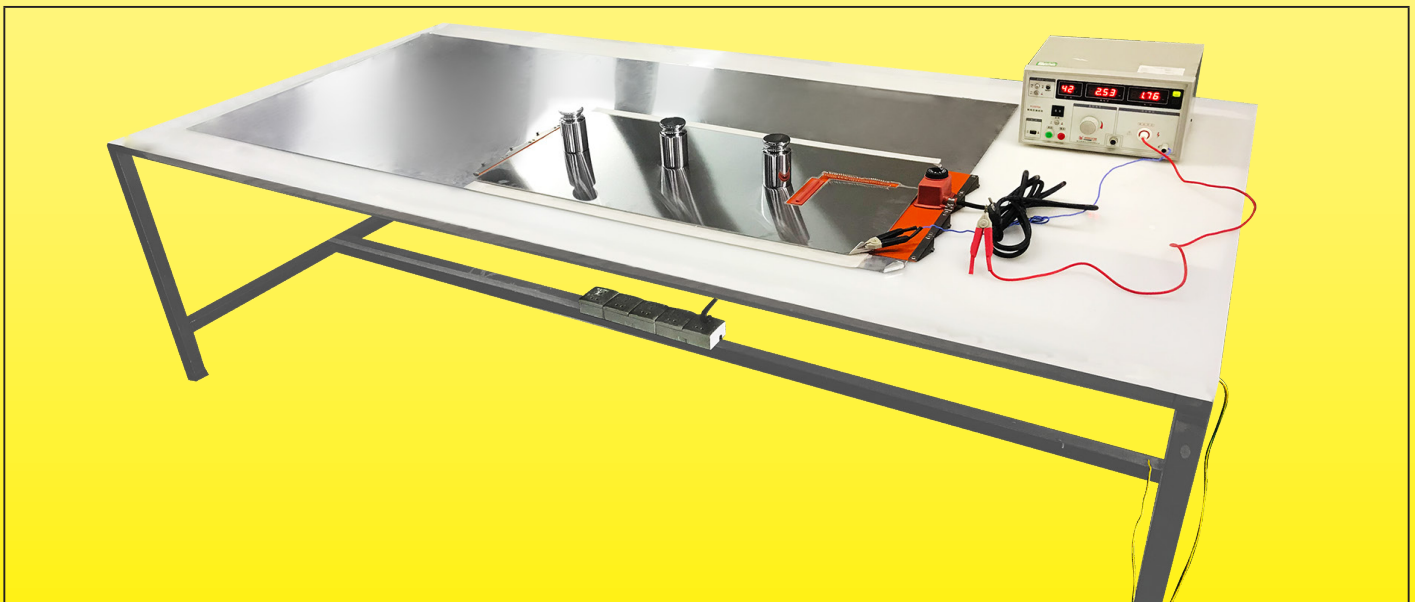
Messgeräte für den Gesamtleckstrom im kalten Zustand
